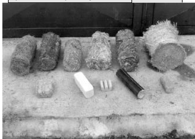
Vzorky komprimovaných biopaliv. V předu bílé brikety: seno, piliny, sláma. V pozadí pakety o průměru 160 mm, zleva: len, saflor, koriandr, konopí, křídlatka. Zcela vpravo tráva - produkt svinovacího kompaktoru, průměr 300 mm.
